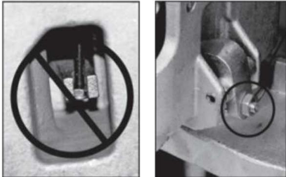
Не регулируйте управление рычагом с помощью стопорной гайки на конце цепи рукоятки. Если нейлоновые стопорные кольца гайки будут повреждены, то в процессе эксплуатации гайка открутится и упадет. При этом управление подъемом и опусканием вил будет невозможно.
